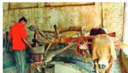
চিত্র ৫.২: ঘানিতে তেল নিষ্কাশন
