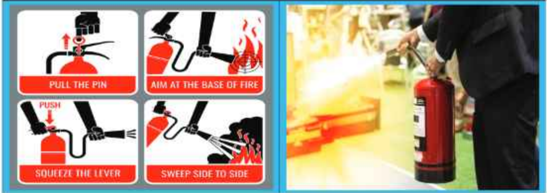
চিত্র: ১.১৮ অগ্নিনির্বাপক যন্ত্র ব্যবহারের কৌশল
